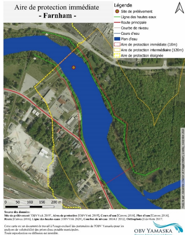
Figure 25 : Aire de protection immédiate du site de Farnham
